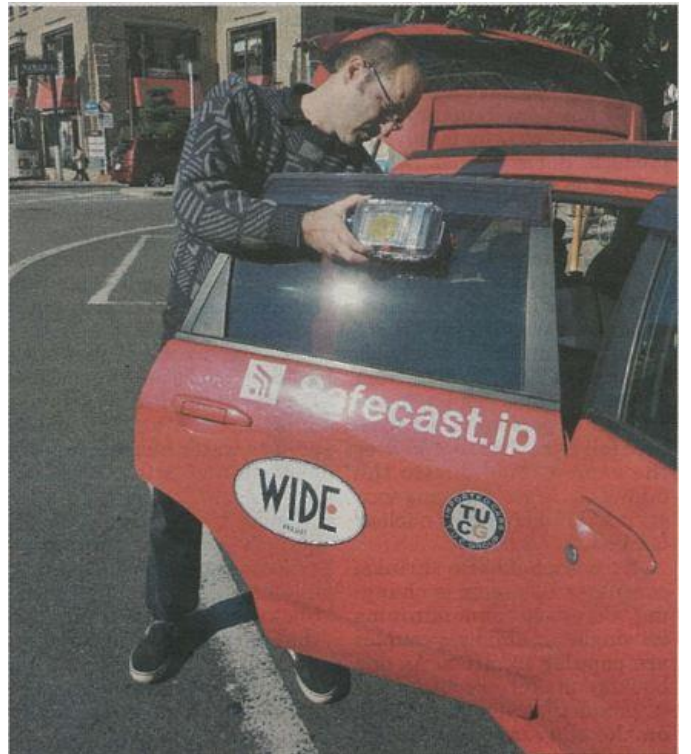
ガイガーカウンターを搭載したクルマで日本のどんな場所でも放射線レベルを測定することが可能
