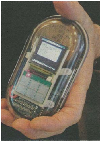
Safecast 向けにインターナショナル・メドコム(International Medcom)社によって開発されたUSBポートつきガイガーカウンター(試作品)
